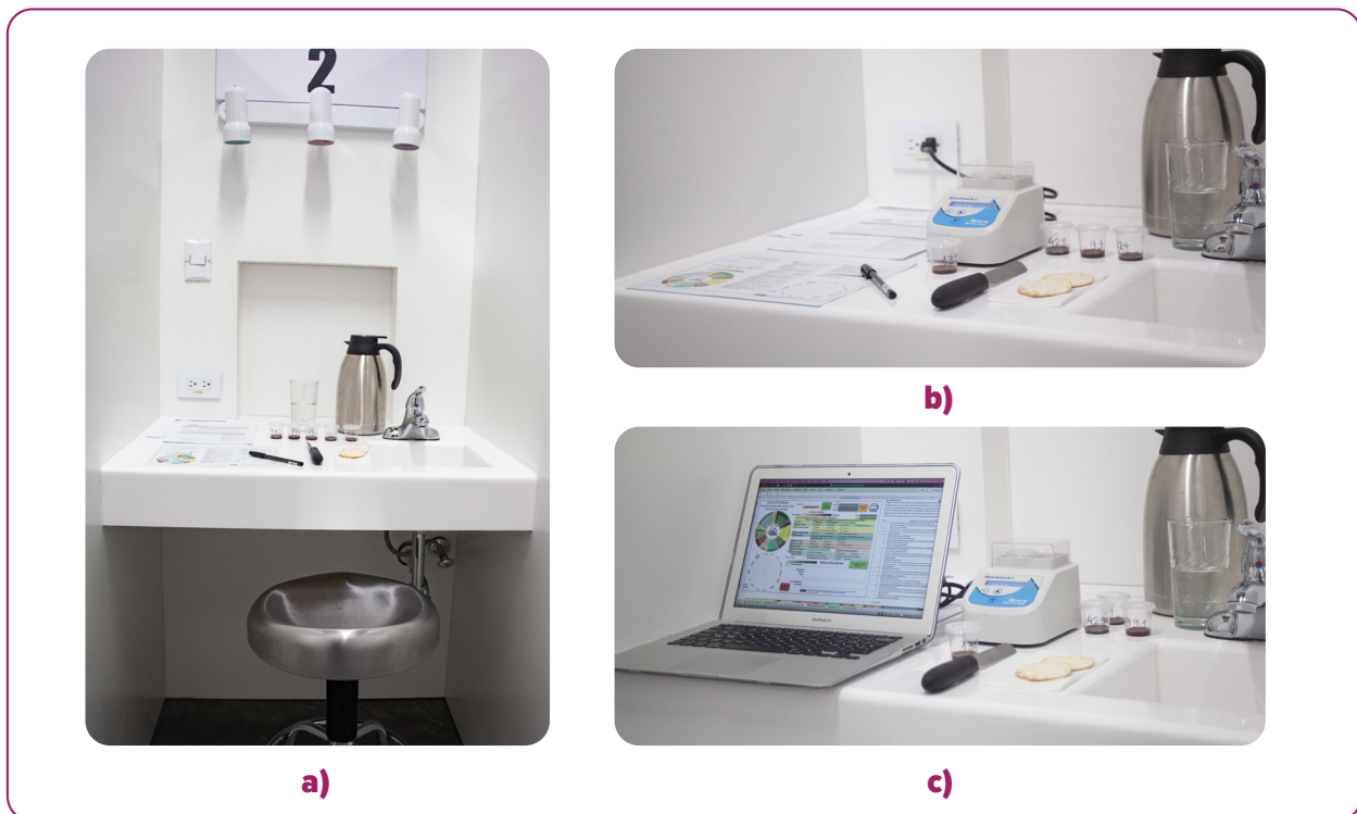
Figure 17. a) Cabine d'évaluation sensorielle équipée d'échantillons, d'un formulaire d'évaluation imprimé, d'une spatule et d'un thermos d'eau ; b) avec équipement de chauffage ; et c) avec équipement de chauffage et ordinateur avec formulaire d'évaluation (Bioversity International, Archila, 2022).
