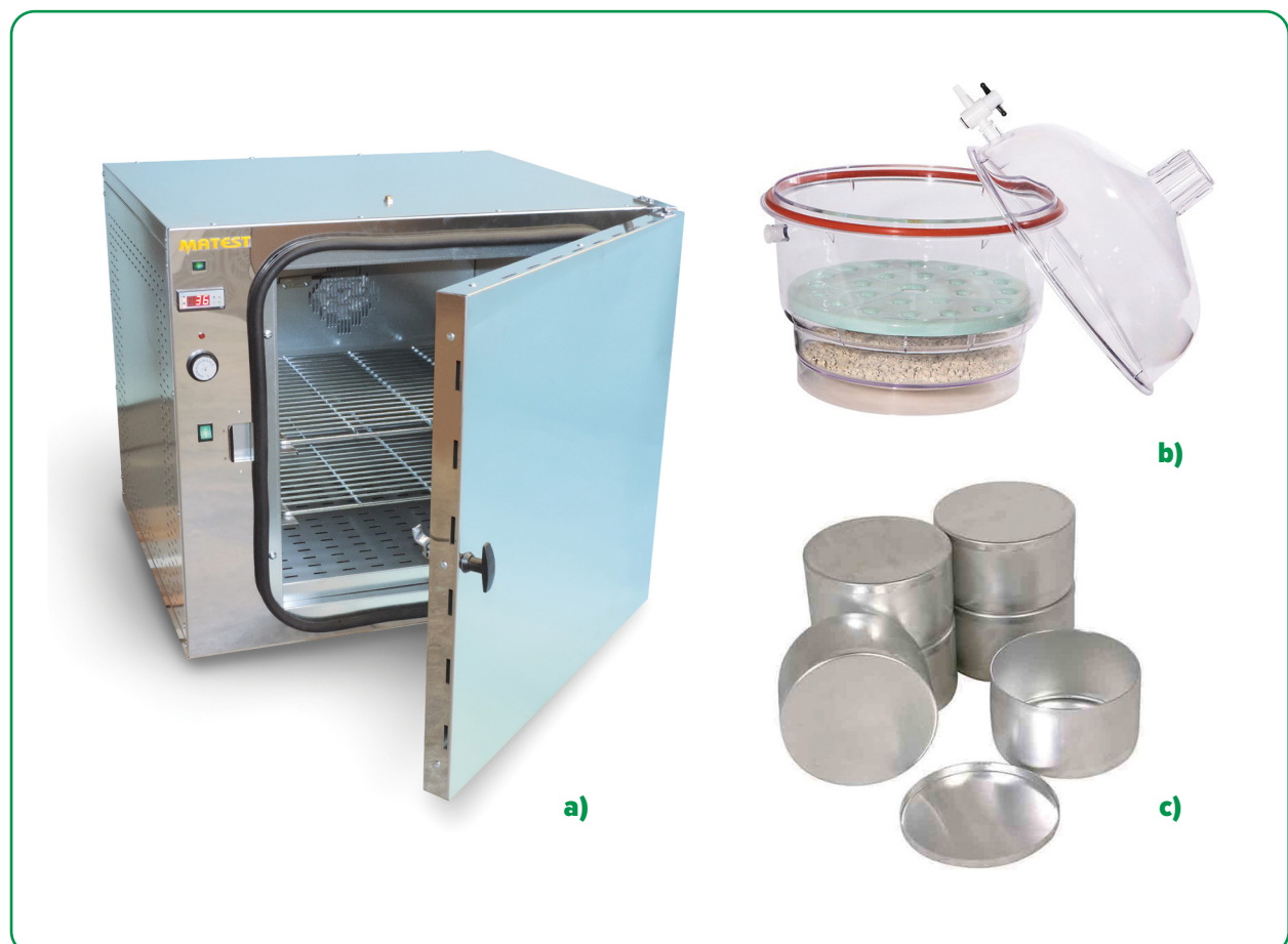
Figure 48. a) étuve, b) déshydrateur ; et c) plats en métal, pour déterminer la teneur en eau par la méthode de séchage à l'étuve ( matest.com ; coleparmer.co.uk ; certifiedmtp.com ).
