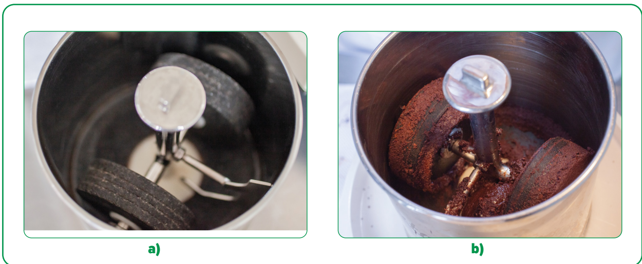
Figure 70. Intérieur du mélangeur : a) vue de l'assemblage de la meule de pierre à l'intérieur du bol de pierre vide ; b) vue du bol du mélangeur pendant le broyage des grués de cacao en masse de cacao ( chocolatemelangeur.com ; chocolatealchemy.com ).
