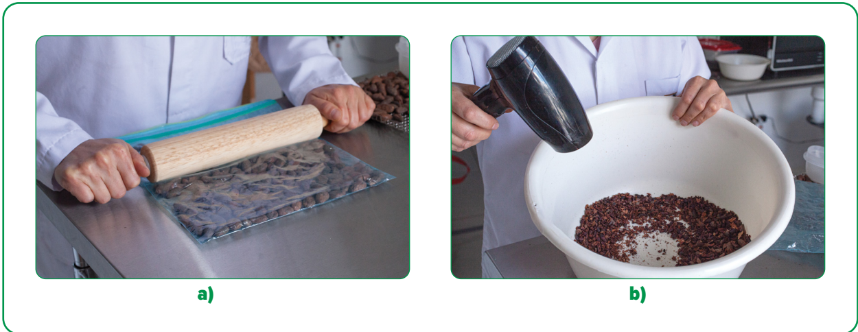
Figure 62. Méthode semi-manuelle de vannage des fèves de cacao. a) rouleau à pâtisserie, b) sèche-cheveux (Bioversity International, Archila, 2022).
