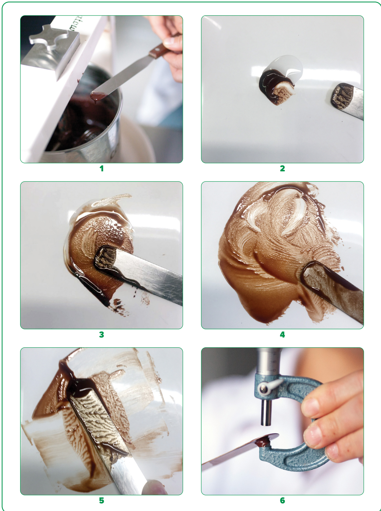
Figure 38. Procédure de préparation de la masse de cacao à l'aide d'huile minérale, pour mesurer la taille des particules à l'aide d'un micromètre (Bioversity International, Archila, 2022).
