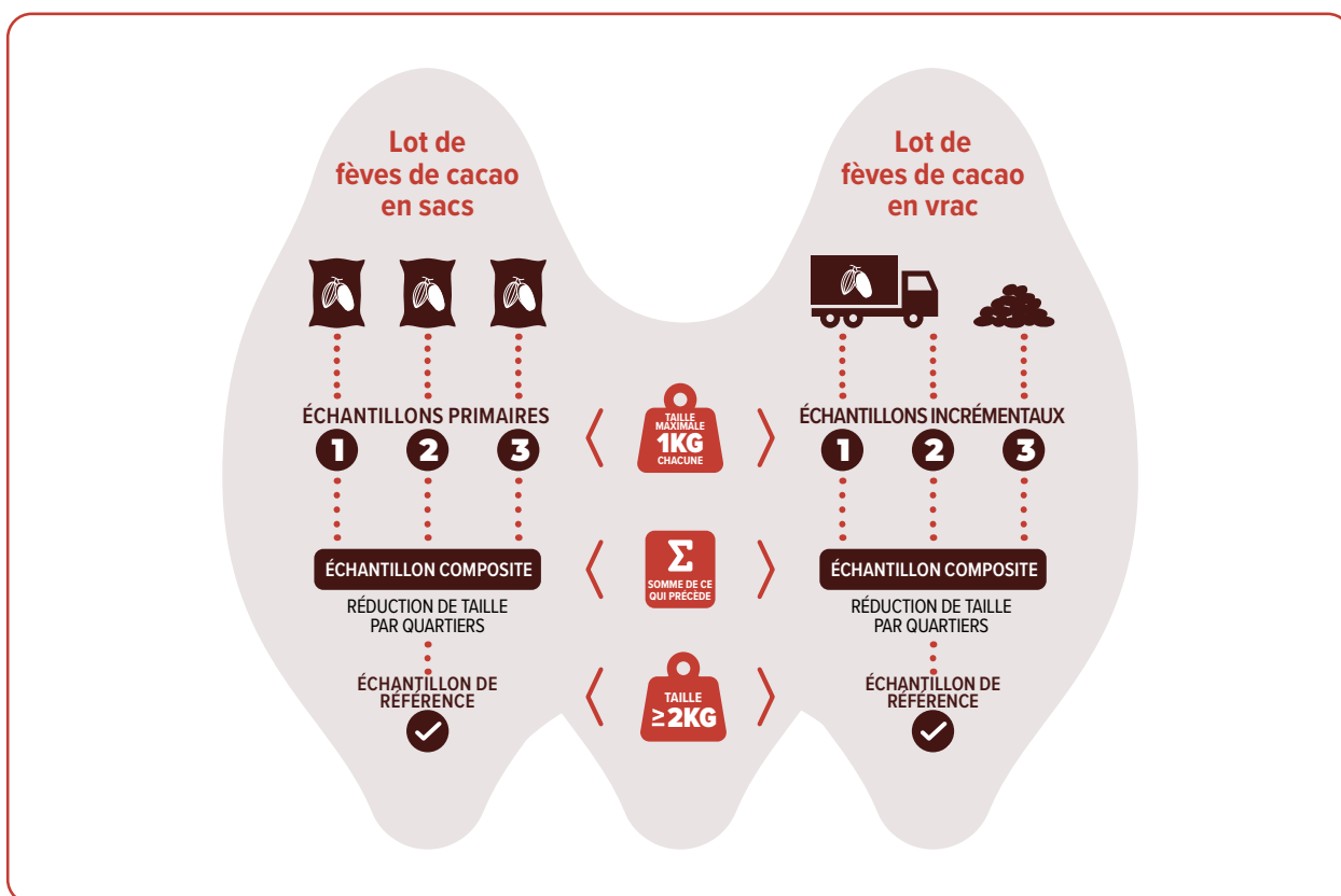
Figure 3. Représentation schématique du processus d'échantillonnage et des types d'échantillons (basée sur : ISO, 2292:2017 et ISO, 2451:2017).
